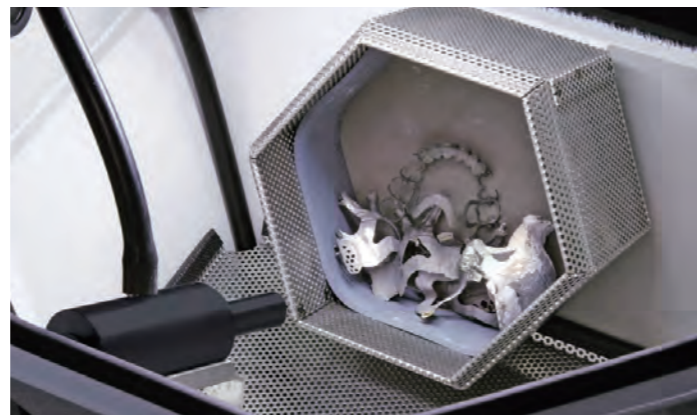
時間とコストの節約：大型の回転式スチールバスケットにより、最大7つの対象物を同時にサンドブラスト処理が可能
