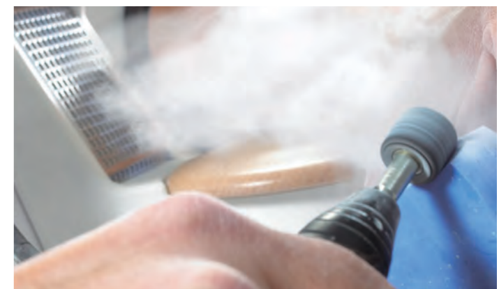
特に大量の粉塵が発生する場合、集塵ボックスダステックマスタープラスが作業台をクリーンに保ちます
