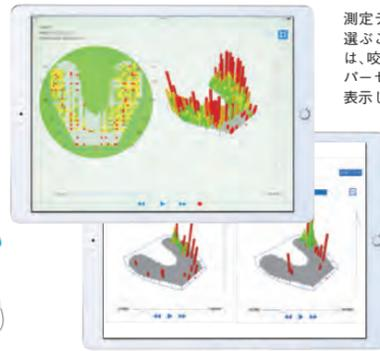
測定データの表示方法をご希望に合わせて選ぶことができます。4分割の圧力分布図は、咬合の偏りによって4色で表示します。パーセンテージは、咬合の偏りを数値化して表示します。
