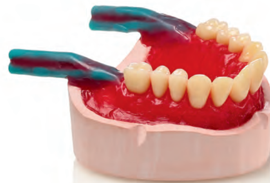
注入孔の追加および模型上に位置確認の印をつける
