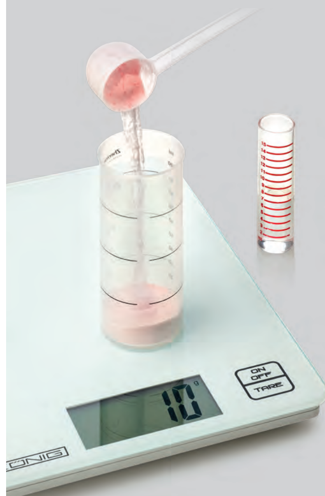
最初にモノマーを計量し、次にレジン量を計量し、この順番で練和する
